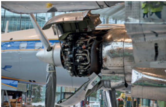
Die vier mächtigen 18-Zylinder-Motoren leisten jeder 3.450 PS und sind so restauriert, dass sie lauffähig wären.
