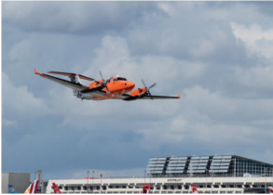
Die King Air 350 der FCS vermisst hier im Bild das ILS am Flughafen Stuttgart.
